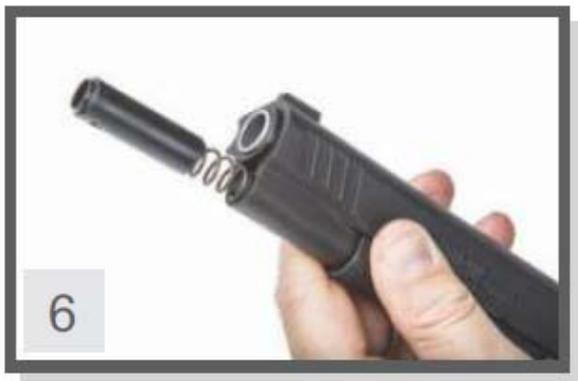
6. Spingete il tubetto e ruotate la boccola in modo che il suo bordo contrasti con il bordo del tubetto, trattenendolo (fig. 7).
