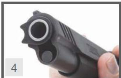
4. Allineate il carrello in modo che la tacca di smontaggio coincida con lo scasso nel telaio per l'estremità posteriore della leva di arresto. Reinserte la leva di arresto (fig. 5).
